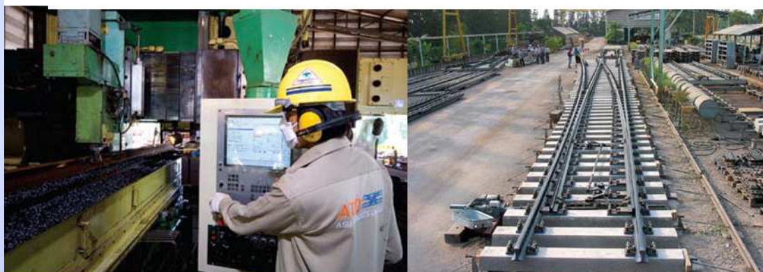
การไสรางรถไฟ ด้วยเครื่อง CNC Milling Machine
